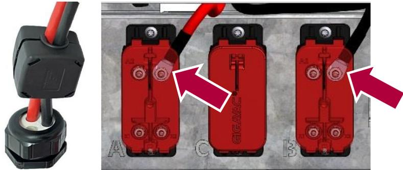
8. Überprüfen, dass die Leistungskabel fest am Relais sitzen. Falls nicht: M4 Muttern verwenden und mit 1,5 Nm anziehen.
