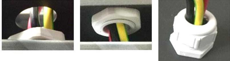
*HINWEIS:* Kabel durch die Überwurfmutter der PG Verschraubung führen und dann durch das Außengehäuse führen.
